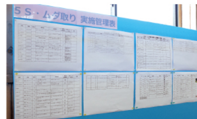
ムダ、非効率、危険箇所が風景化しないよう毎日15分間の5S活動を実施し、内容を貼り出している
